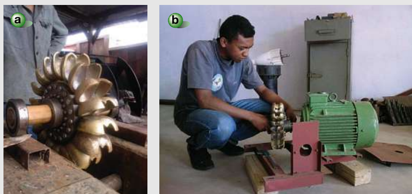
Figure 4 Construction de la pico-turbine Pelton à l'atelier malgache de l'ONG.
