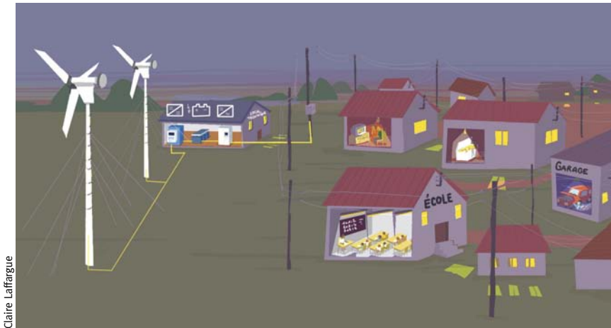
Deux éoliennes d'une puissance identique (6 kW) sont installées en parallèle puis associées à un miniréseau de distribution. / Two identical 6-kW capacity wind turbines are installed in parallel then hooked up to a mini distribution grid.
